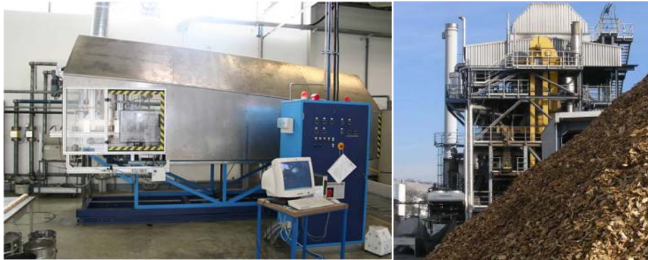
图 5(左) 我们在奥地利的催化反应器 (C-Polymer); (右) 在奥地利 Guessing 的气化反应器
